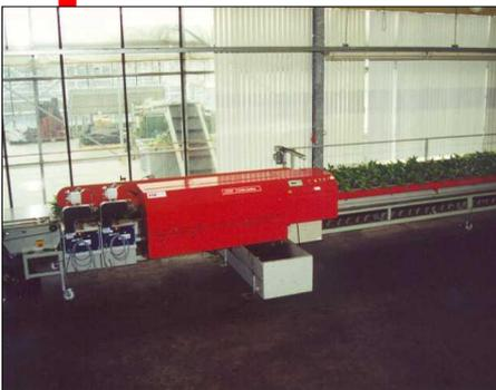
Die T4100 ist computergesteuert. Dadurch ist die Abstimmung mit den Bindemaschinen und den anderen Komponenten gewährleistet
