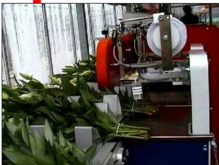
Bei der Formgebung der Maschine ist auf grösste Funktionalität geachtet worden. Der Geräuschpegel und die Vibrationen sind auf ein minimum reduziert worden. Weiterhin ist die Kabel-führung sowie der Aufbau und die Lage des Schaltkastens vorbildlich gelöst worden.
